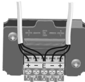
Рис. 6 Схема подключения шлейфа сигнализации в извещателе
