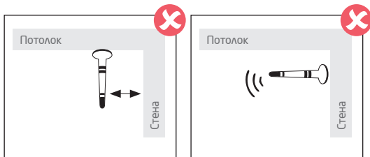
Рис. нр. 8 Неправильное крепление антенны под потолком
