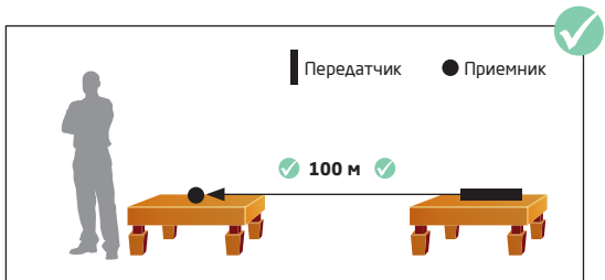
Рис. нр. 12 Передатчик и приемник установлены на деревянную поверхность, напротив друг друга
